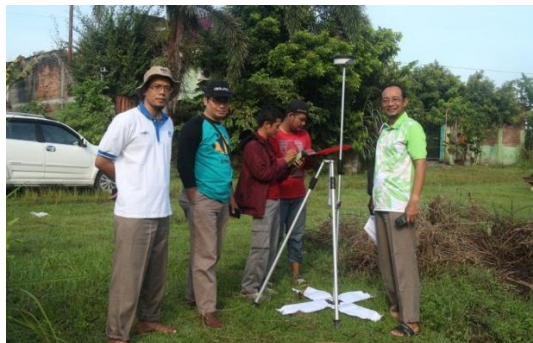
Gambar 5. Pengukuran Premark GCP di Perumahan.
