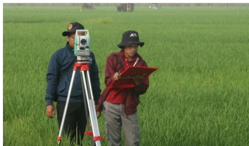
Gambar 8. Pengukuran Bidang Tanah secara Terestris Bidang Tanah I
