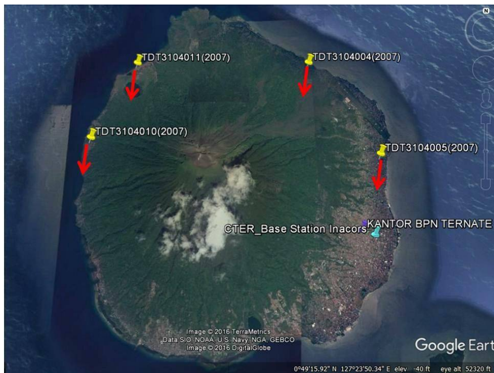
Gb. 25. Pola Deformasi Titik Dasar Teknik di Pulau Ternate
